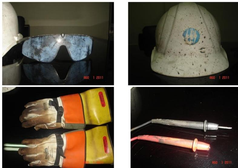
Tercer accidente: Un operario retiró la cubierta superior de un disyuntor termomagnético para realizar mediciones de tensión en bornes de ingreso. Cuando apoyó las puntas de prueba, giró la cabeza para leer valores en el instrumento, en ese momento una de las puntas de prueba resbaló y provocó
